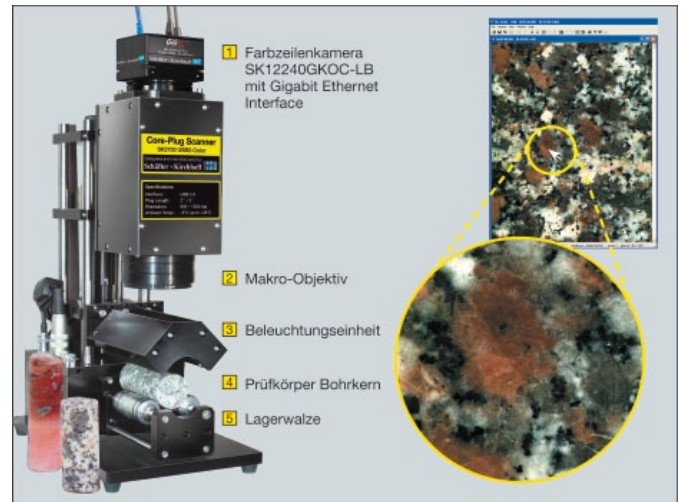
ABB. 5: Der Core-Plug-Scanner, ein mobiles zeilenkamerabasiertes Bilderfassungssystem, wurde für die Inspektion von geologischen Prüfkörpern entwickelt. Mit dem robusten Gerät erfolgt die Datenerfassung direkt am Ort der Probebohrungen.
